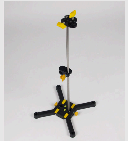
Montaje de las dobles nueces en la barra de soporte
